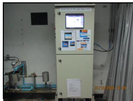
ภาพถ่ายที่ 2.2.2-11 pH, Temperature, Dissolved Oxygen และ COD Analyzer Online
